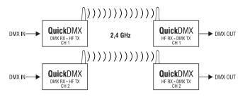
Es können 6 DMX-Funknetze mit 6 Sendern parallel betrieben werden, ohne dass sie sich gegenseitig stören. Dazu werden alle Sender auf einen unterschiedlichen Übertragungskanal eingestellt. Die Übertragungsstrecken arbeiten unabhängig voneinander und können sowohl im Modus 1:1 oder 1:mehrere eingesetzt werden.
