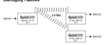
Das DMX-Signal wird bei einem Sender eingespeist und von diesem per HF gesendet. Mehrere Empfänger mit identischem Übertragungskanal empfangen das HF-Signal und geben es als DMX-Signal aus.
